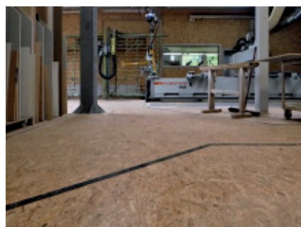
Weniger Transport: Eine Stufe im Werkstattboden wurde ausgeglichen. So konnten Säge, Kantenanleimer und Werkzeugmaschine in einem Dreieck dicht zueinander aufgestellt werden.
